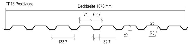
**Dreifeldträger** Endauflagerbreite  $l_{a,A} = 40\text{mm}$  Zwischenaflagerbreite  $l_{a,B} = 120\text{mm}$
