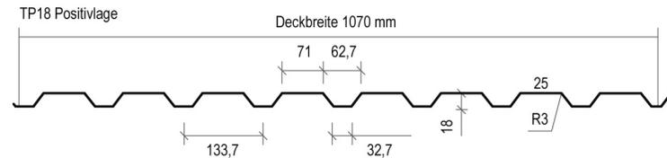
**Zweifeldträger** Endauflagerbreite  $l_{a,A} = 40\text{ mm}$
