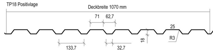
**Dreifeldträger** Endauflagerbreite  $l_{a,A} = 40\text{mm}$  Zwischenaflagerbreite  $l_{a,B} = 60\text{mm}$
